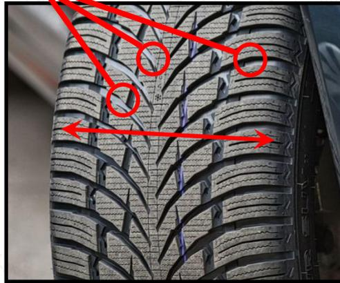
Info : Si vous prêtez attention aux petites élévations dans les rainures de la bande de roulement, appelées Tread Wear Indicator, vous pouvez déterminer la hauteur de 1,6 mm.
